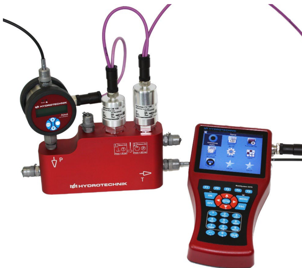
Abbildung 8: Service-Mess-Set angeschlossen am MultiSystem 5070
